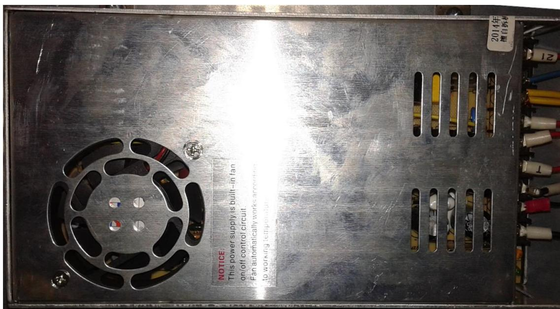
Figura 34 - Transformador 230V/36V.
