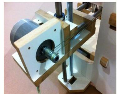
Figura 6- Junta com transmissão por cabo [22]
