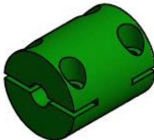
**Figura 47 - Modelo do 1º Acoplamento.**
