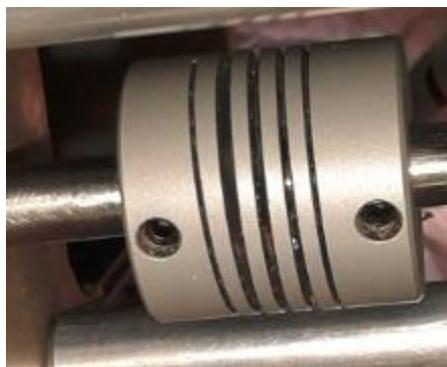
**Figura 48 - Acoplamento flexível.**
