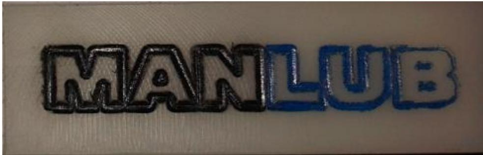
**Figura 53 - Gravação em peça de nylon.**
