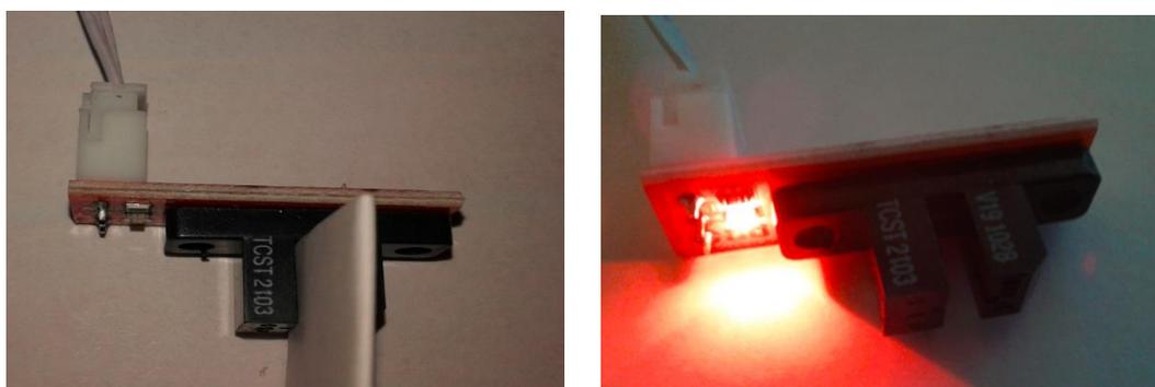
**Figura 36 - Sensor ótico interrompido e aberto.**
