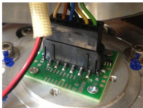
Figura 4.12 – Sensor de posição magnético RMB28SC da RLS .
