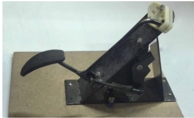
Figura 4.14 – Acelerador eletrônico utilizado na aplicação final.
