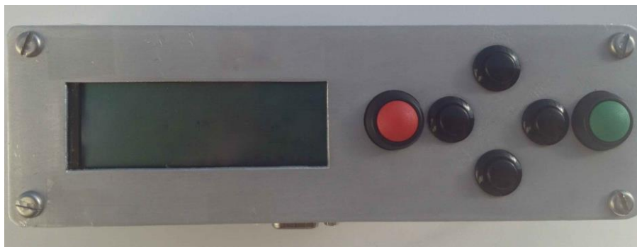
Figura 4.28 – Painel de monitorização do Controlador.
