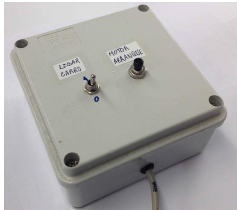
Figura 4.29 – Dispositivo utilizado para simular a chave de ignição de um automóvel.
