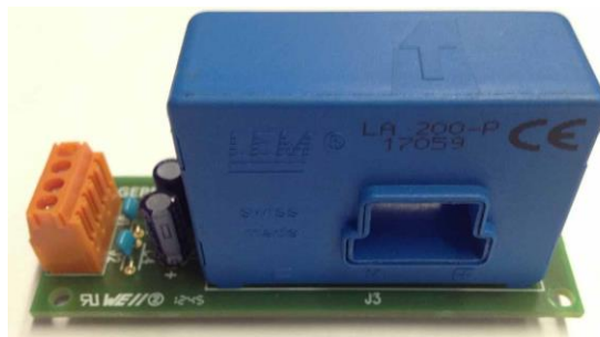
Figura 4.11 – PCB utilizada para obter o valor da corrente consumida por uma fase do motor.
