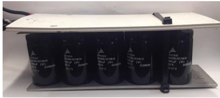
Figura 4.24 – Associação de condensadores com tensão máxima de 900 V e uma capacidade de 2,5 mF.
