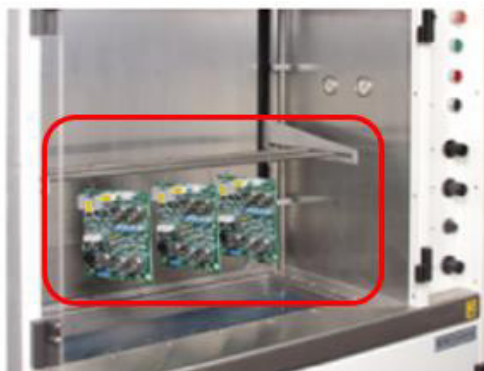
Figura 16. Carrier utilizado no coating por mergulho (Adaptado de (SCH Technologies, 2012)).
