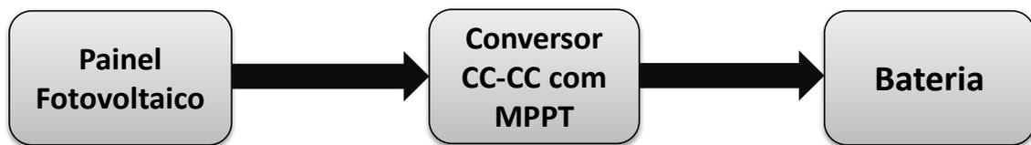
Figura 3.1 - Diagrama de bloco do sistema de carregamento da bateria.
