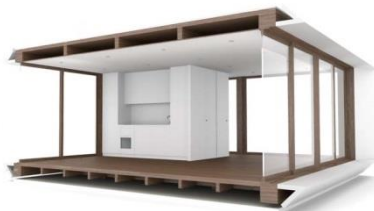
Figura 59 – Estrutura em madeira da MIMA HOUSE
