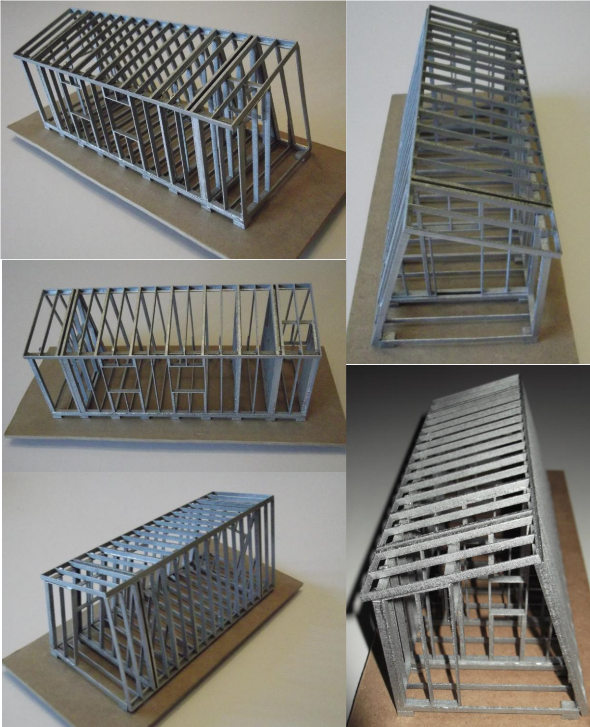
Figura 184 – Vistas da maqueta (estrutura do edifício)
