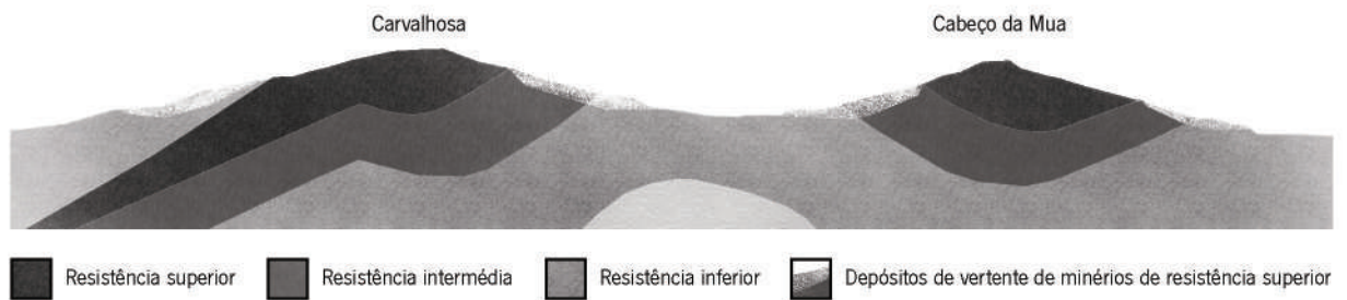
Figura 48: Secção representativa das áreas onde se demonstra a resistência dos constituintes do solo do Sinclinal de Moncorvo.
