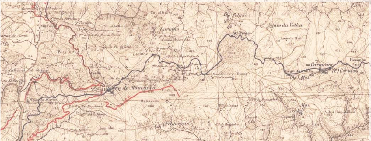
Figura 90: Traçado da linha do Sabor, abrangendo o trajeto desde a Estação do Pocinho ao Sinclinal de Moncorvo, sobre a Carta Militar de 1900. (Anexo I) Fonte: Cartoteca
