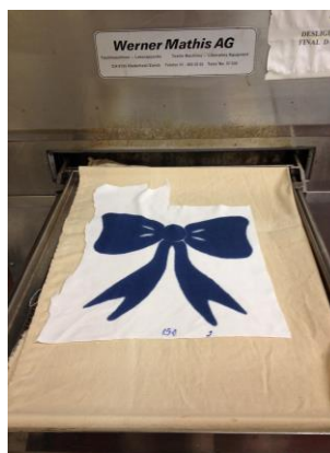
Figura 30- Máquina de polimerização. Malha antes de aquecer. Fonte: Elaboração própria
