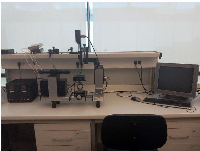
Figura 2.20: Equipamento de ângulo de contacto, do Departamento de Polímeros utilizado nas medições.
