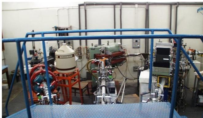
Figura 2.11: Acelerador Van de Graaff de 2.5 MV [29].
