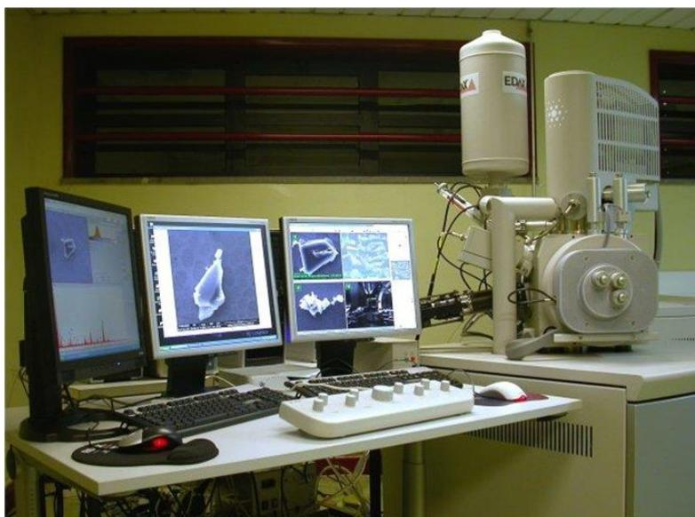
Figura 2.15: Microscópio eletrônico de varrimento - CEMUP.
