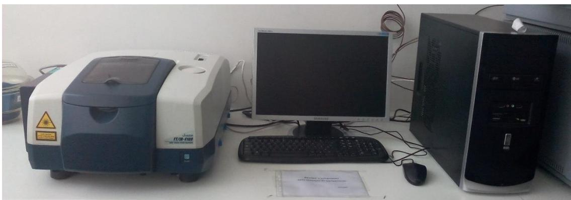
Figura 2.23: Equipamento de FTIR, do Departamento de Polímeros da Universidade do Minho, utilizado para as análises.
