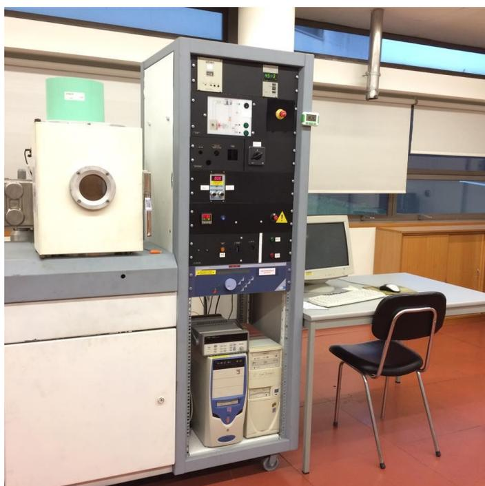
Figura 2.6: Sistema de deposição utilizado na produção dos filmes finos de Ti-Me (Me = Al, Au).
