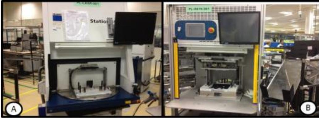
Figura 18 - A - Máquina Gravação; B - Máquina Cravação
