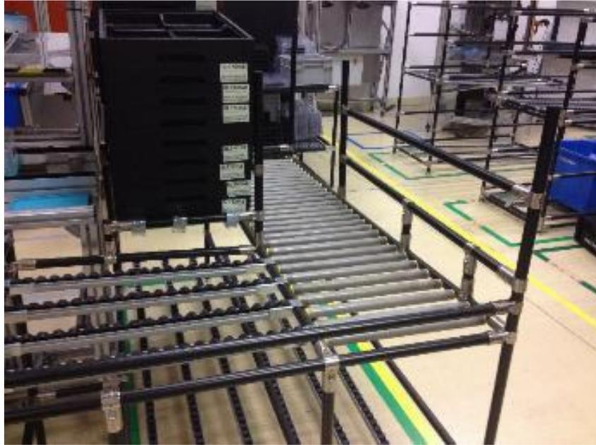
*Figura 31 – Rampa de alocação de material*
