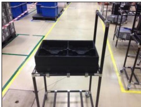
*Figura 22 - Carro para colocação do output das LMF*
