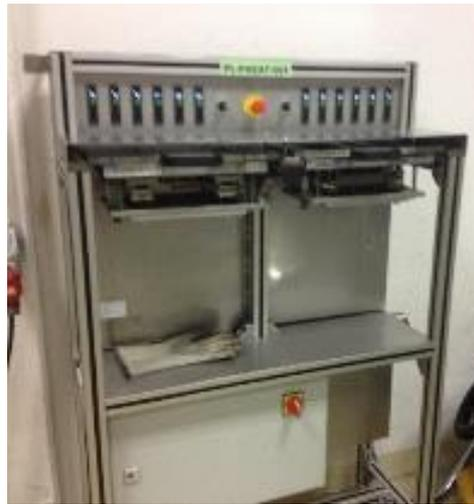
*Figura 37 - Máquina de pré aquecimento das bases de cravação*
