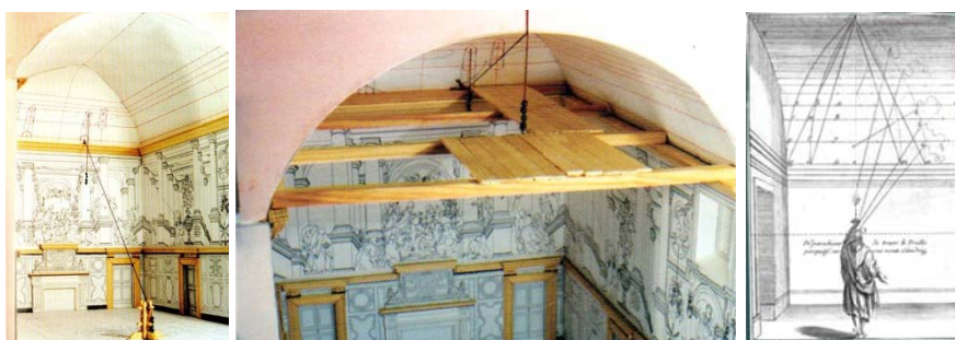
Modelo interpretativo do método dos fili tesi de Vignola na delineação da abóbada da Sala Clementina (DI MARZIO 1999, 167 e 173). Abraham Bosse : Le Moyen universel (1653, Paris), prancha 15.
