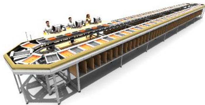
Figura 9. Sistema de separação automatizada do tipo Bomb-bay .
