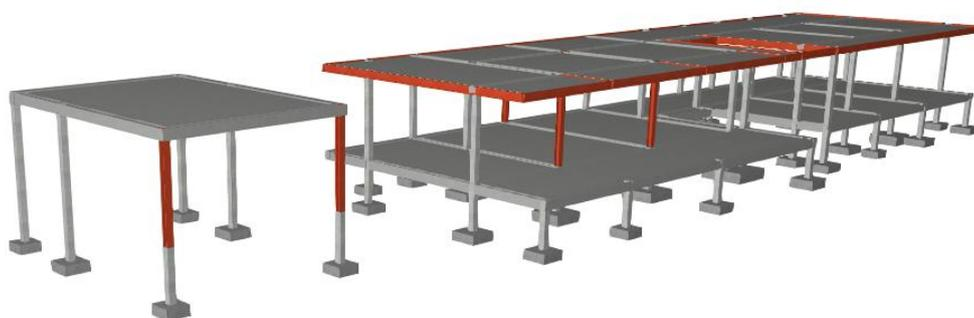
Figura 20 Estabilidade de uma moradia isolada utilizando o *Software* CypeCAD<sup>®</sup>.
