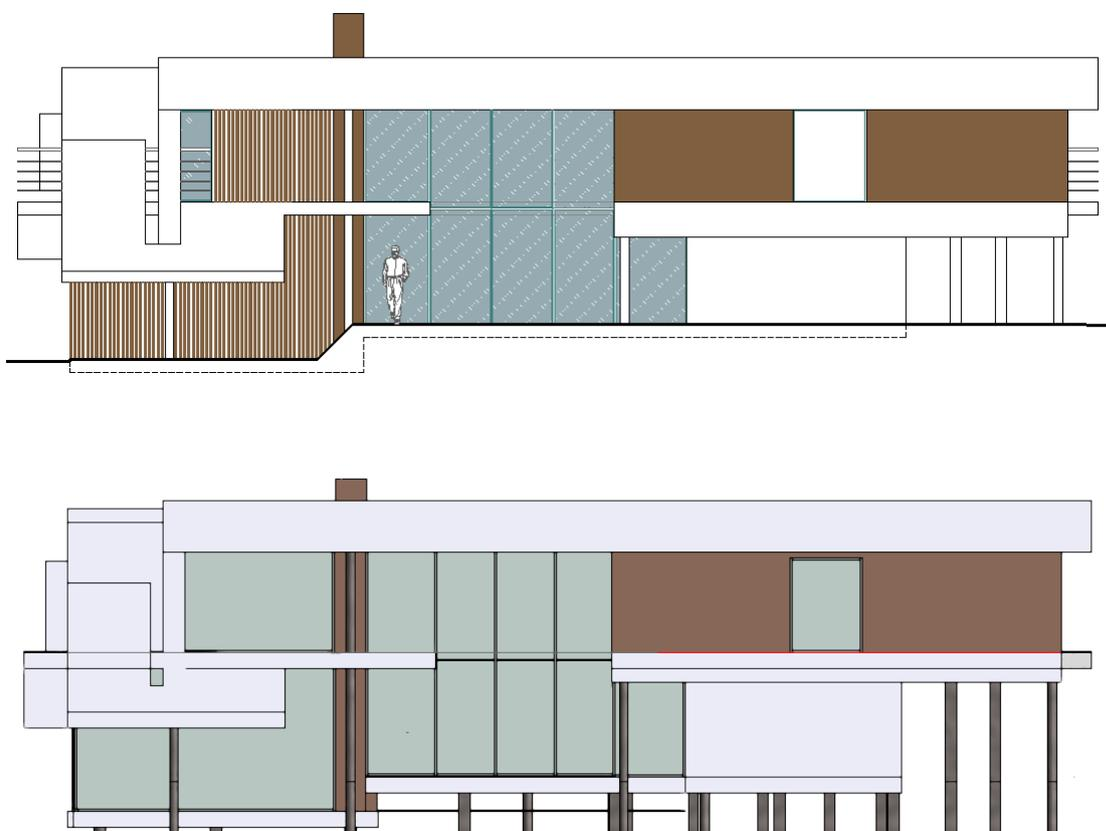
Figura 32 Representação do Alçado Norte (a) Desenhos em CAD (superior) e (b) Desenho em BIM (inferior).
