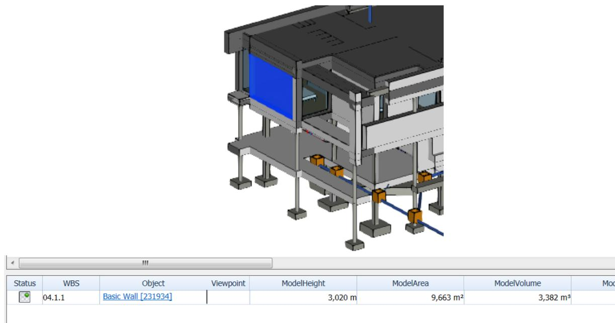
Figura 40 Listagem automática das quantidades através do NavisWork<sup>®</sup>.
