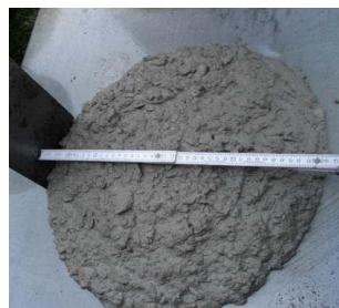
Figura 24 – Medição da dimensão máxima do espalhamento do betão segundo duas direções d_1 e d_2 (mm)
