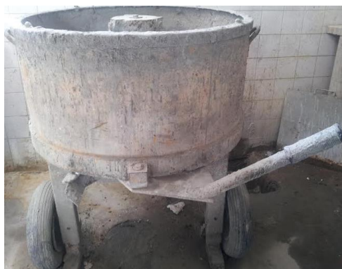
Figura 22 – Betoneira da amassadura com capacidade de 90 lt
