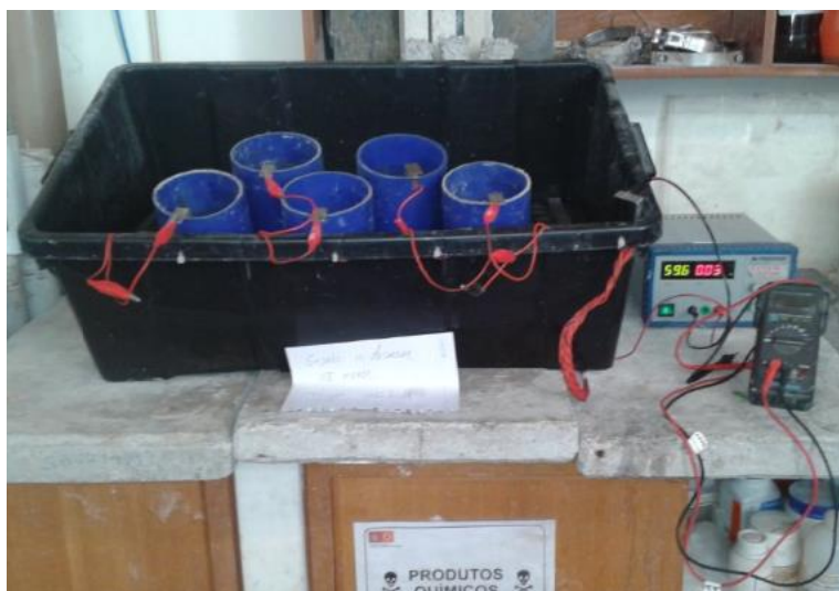
Figura 42 – Esquema de ensaio penetração de cloretos usado no laboratório materiais de construção da Universidade do Minho
