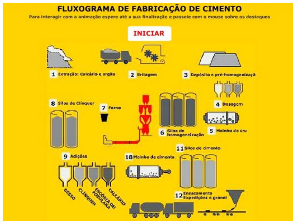
Figura 2 - Processo de fabricação de cimento
