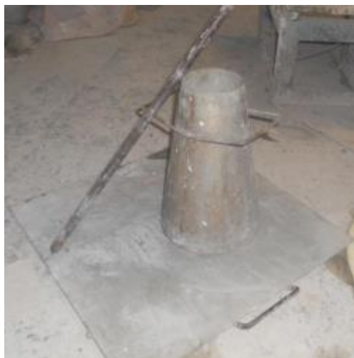
Figura 25 – Realização do ensaio de abaixamento com o cone de Abrams
