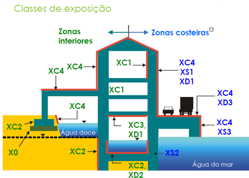
Figura 5 – Classes de exposição de acordo com as zonas em que se aplica determinado tipo de betão [20]
