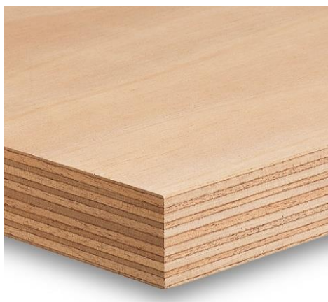
Figura 13 - Aspeto de um contraplacado (in www.banema.pt )
