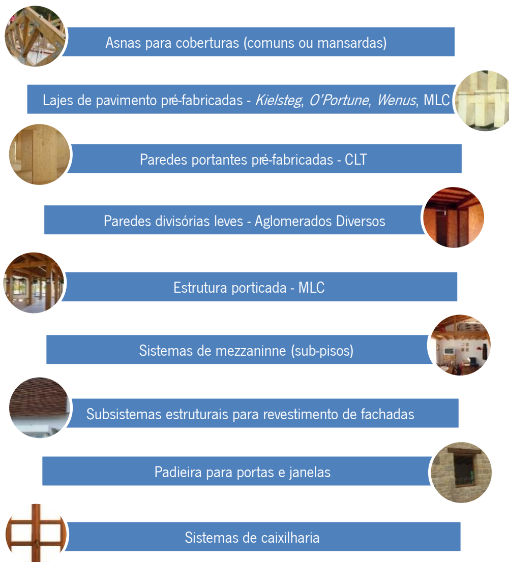
Figura 37 – Soluções construtivas à base de elementos pré-fabricados de madeira
