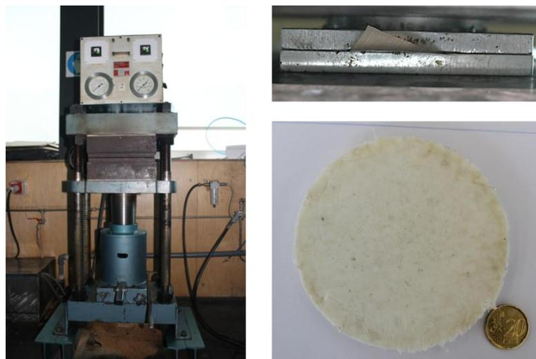
Figura 3:5 - À esquerda: Prensa Moore; À direita: Processo de moldação por compressão e espuma resultante.
