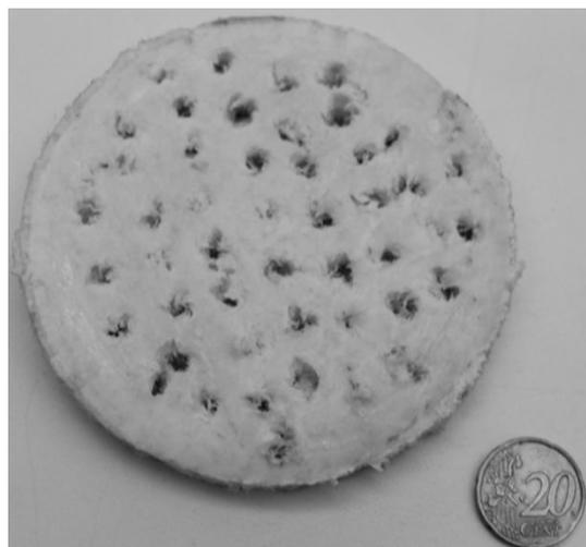
Figura 4:14 - Representação da deformação obtida na espuma com perfuração de 8 mm.
