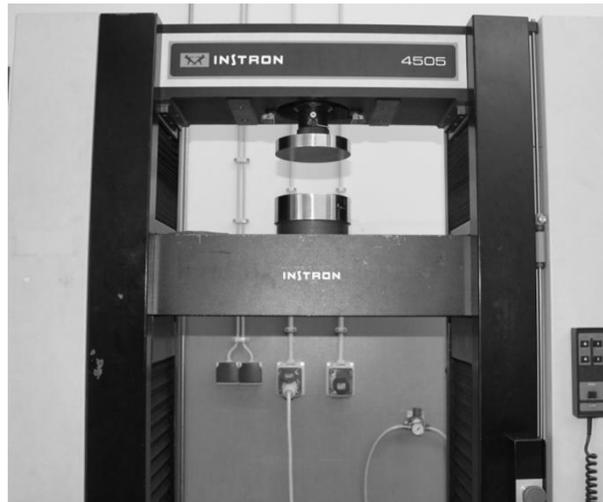
*Figura 3:10 - Equipamento utilizado no ensaio de resistência à compressão - Máquina universal de ensaios mecânicos, INSTRON 4505.*
