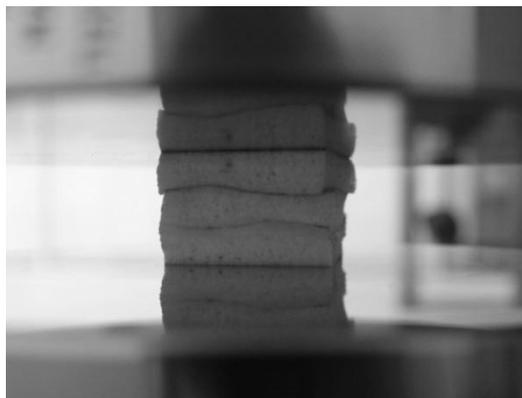
*Figura 3:11 - Amostra comprimida no ensaio de resistência à compressão.*
