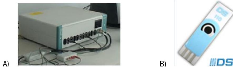
**Figura 5:** A) Potenciostato Autolab PGSTAT30. Fonte: <http://www.egr.msu.edu/~scb-group-web/blog/wp-content/uploads/2012/07/200746395941732.jpeg> B) Eléctrodos serigrafados com eléctrodos de trabalho e auxiliar de carbono e eléctrodo de referência de prata da DropSens (C110). Fonte: <http://www.dropsens.com/en/img/products/electrodos/110.jpg>
