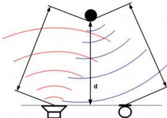
Figura 14 - Funcionamento do Sensor Ultrassom
