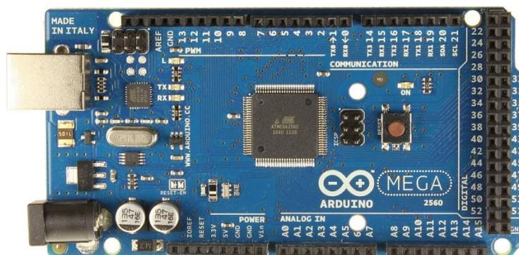
Figura 10 - Microcontrolador Arduino Mega
