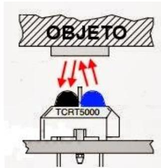
Figura 17 - Funcionamento Sensor Ótico
