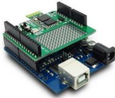
Figura 37 - Conexão entre a placa Arduino e a Bluetooth Shield
