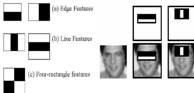
Figura 27 - Exemplo e funcionamento das Haar-like features
