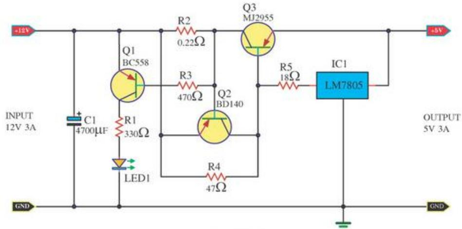
Figura 30 - Circuito Step-down
