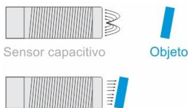
Figura 19 - Funcionamento Sensor Capacitivo
