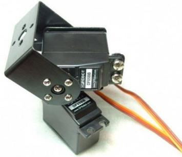
Figura 32 - Estrutura da cabeça do robô
