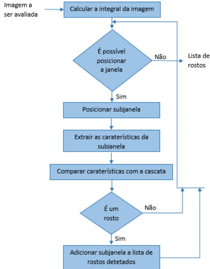
Figura 29 - Processo de deteção de um rosto numa imagem
