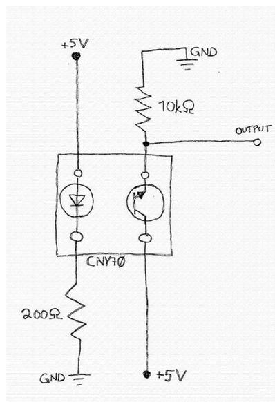
Figura 33 - Funcionamento do sensor óptico
