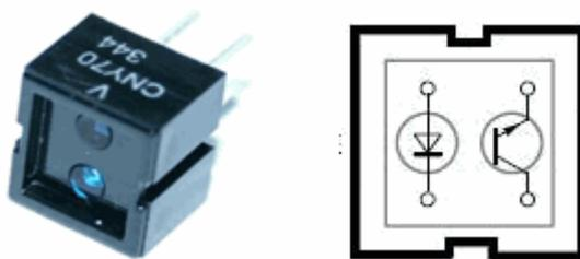
Figura 18 - Sensor Ótico
