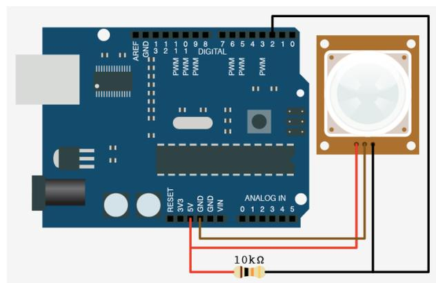
Figura 36 - Implementação do sensor PIR na placa Arduino
