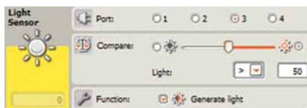
Fig 1. Este programa gera luz artificial através de um LED quando a luz natural está abaixo de um valor limiar (nesta imagem o valor limite é definido como 50). Observe que a função “generate light” está ativada apenas para o segundo ícone contido no loop.
