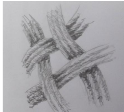
Figura 22- Padrão simples, duas direções perpendiculares, variação número de fibras/ possível alteração de espaçamento com mesmo número de fibras e direcção.
