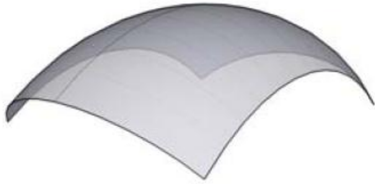
Figura 6- Synclastic curvatura em ambos os lados no mesmo sentido.
