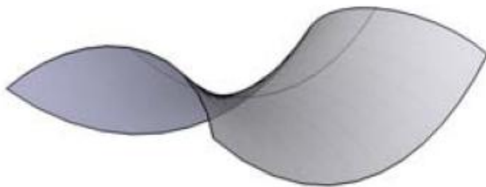
Figura 8- Anticlastic, curvatura em ambos os lados, opostas.
