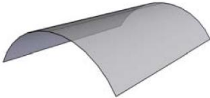
Figura 7- Synclastic, Curvatura num só lado.
