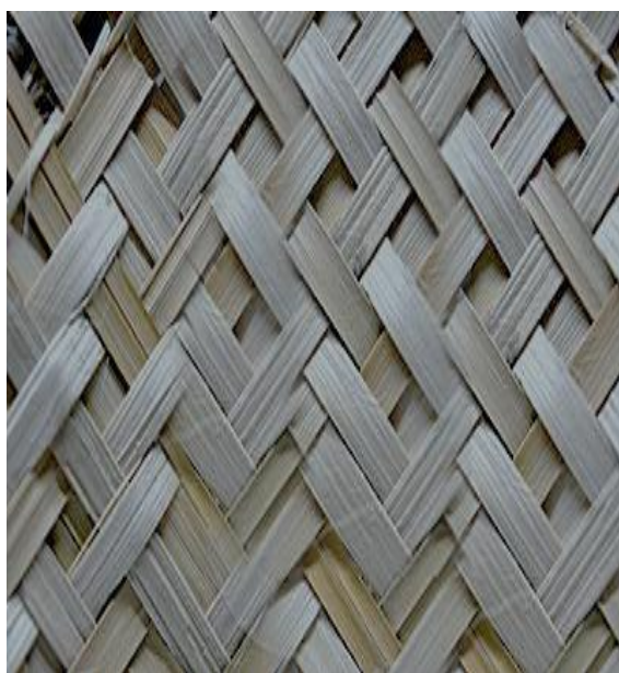
Figura 24- Padrão simples com variação na angulação/ possível variação de fibras com o mesmo padrão.
