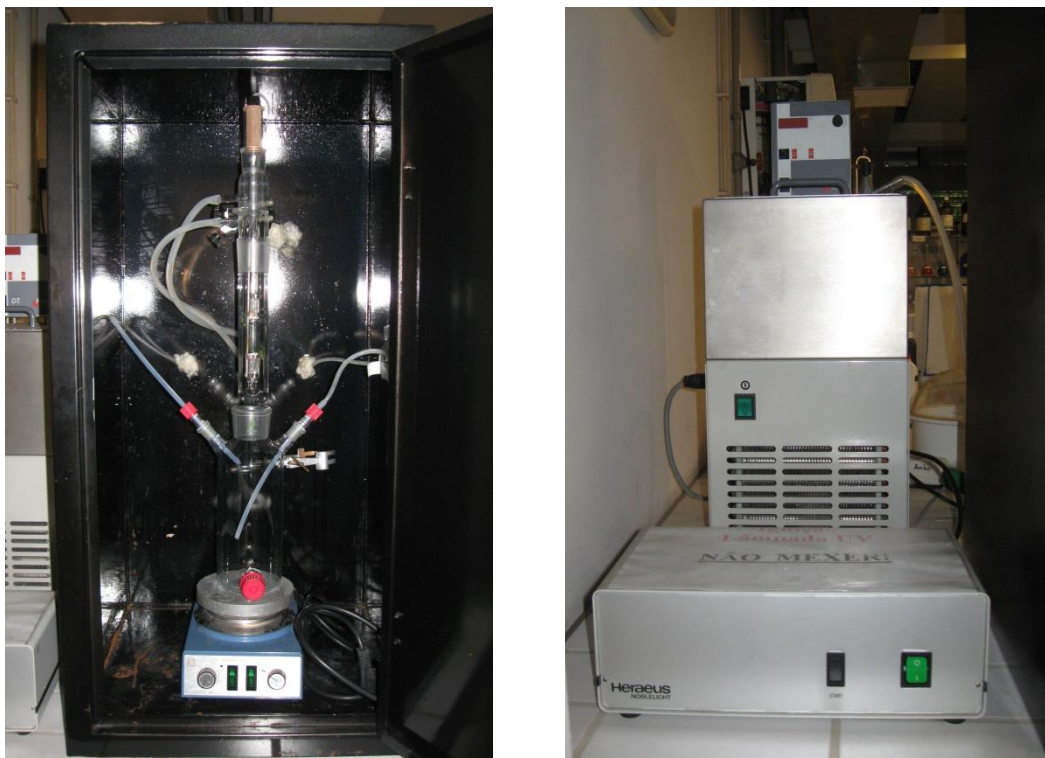
Figura 8 – Reator com lâmpada UV, sistema de refrigeração e dispositivo de ativação
