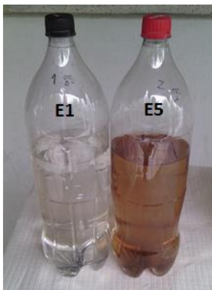
Figura 20 – Aspeto final das soluções de [\text{OTC}]_0 = 20 \text{ mg.L}^{-1} preparadas com água destilada (E1) e com água de abastecimento (E5), expostas à radiação solar
