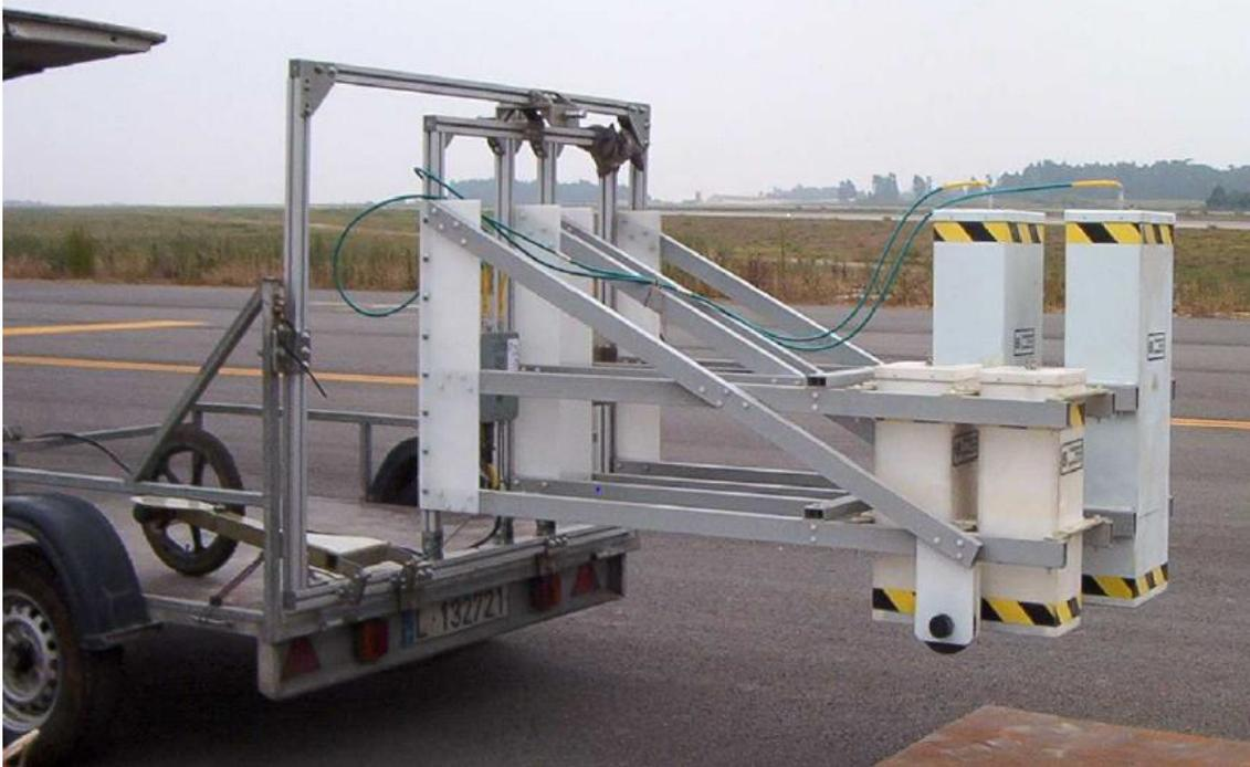
Figura 2.7 - Aspeto das antenas do radar de prospecção do LNEC em posição de ensaio
