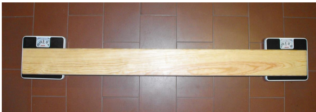
FIGURA 1 - DEMONSTRADOR PONTO DE APLICAÇÃO/REAÇÃO
