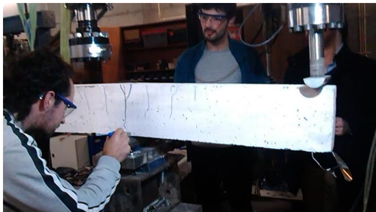
Figura 4.8 – Ensaio da Viga de Betão armado
