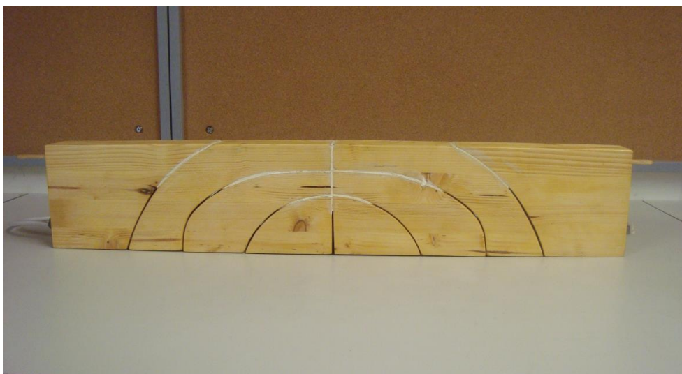
Figura 4.1 – Modelo de viga de betão armado fissurada
