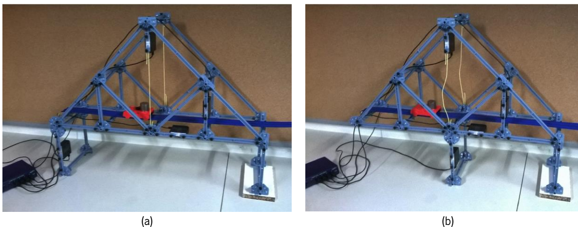
Figura 6.1 - Estrutura apresentada em Mecânica de Estruturas: com apoio na extremidade (a) e com apoio no nó central, mostrando um mecanismo (b)
