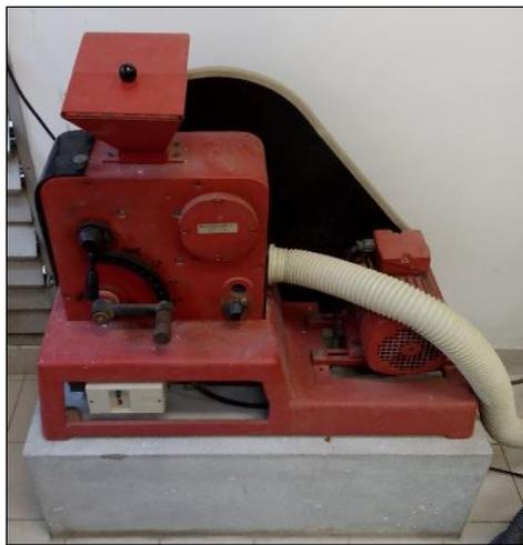
**Figura 9** – Equipamento utilizado para trituração do quartzo (homogeneização da granulometria).
