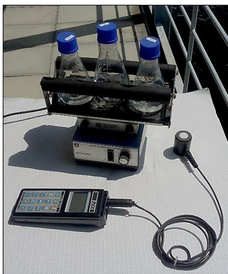
**Figura 12** – Instalação experimental empregue nos ensaios fotocatalíticos preliminares.
