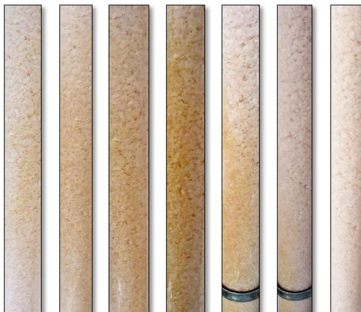
**Figura 35** – Evolução da regeneração do meio poroso funcionalizado ao longo do ensaio “E8\_20\_4\_SF” realizado no filtro reativo.
