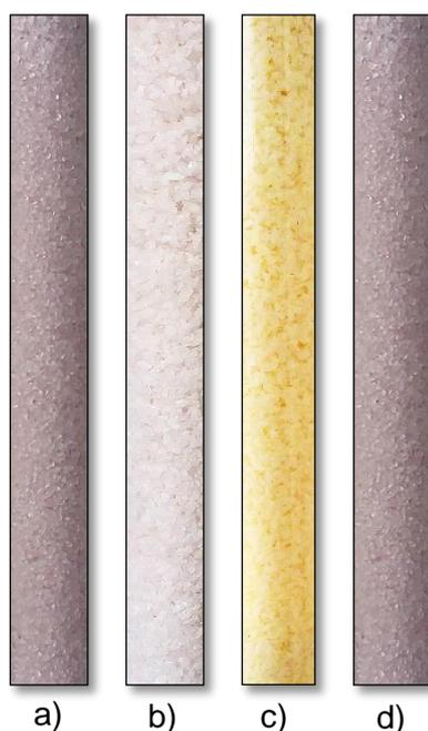
**Figura 18** – Pormenor do aspeto final do meio poroso: a) quartzo sem  $TiO_2$ ; b) quartzo com  $TiO_2$ ; c) quartzo com  $TiO_2$  saturado; d) quartzo sem  $TiO_2$  após ensaio de adsorção.
