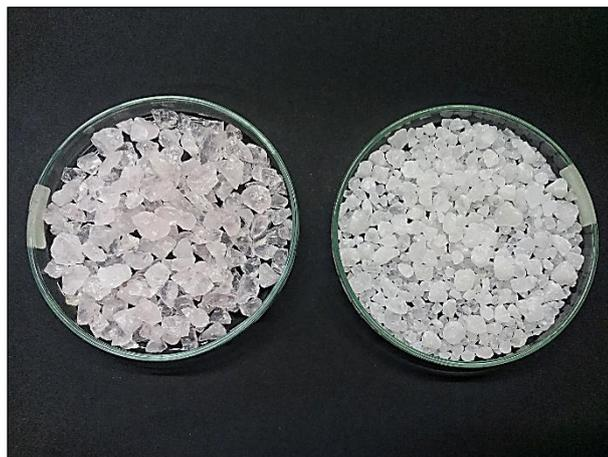
**Figura 10** – Amostras dos grãos de quartzo rósea (esquerda) e branco (direita) após trituração.
