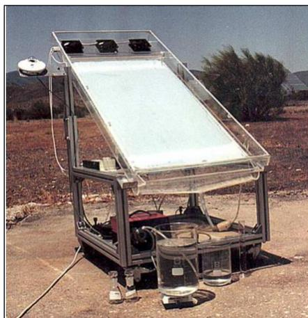
**Figura 6** – Reator fotocatalítico.
