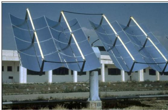
**Figura 5** – Reator solar cilíndrico parabólico
