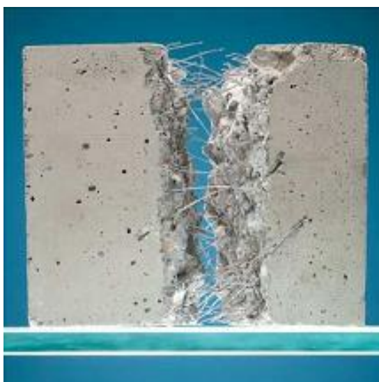
Figura 17 - Argamassa com reforço FRCM
