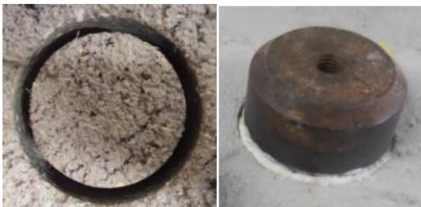
Figura 28 - Abertura de ranhura e colagem de pastilha.
