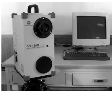
Figura 68 – Aparelho de “3D laser scanning”.
