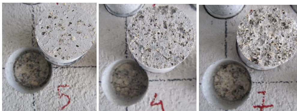
Figura 31 - Rotura obtida na superfície serrada, jato de areia e bujardada.
