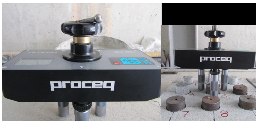
Figura 29 - Equipamento utilizado no ensaio pull-off.
