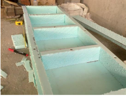
Figura 36 - Molde de polistereno extrudido.
