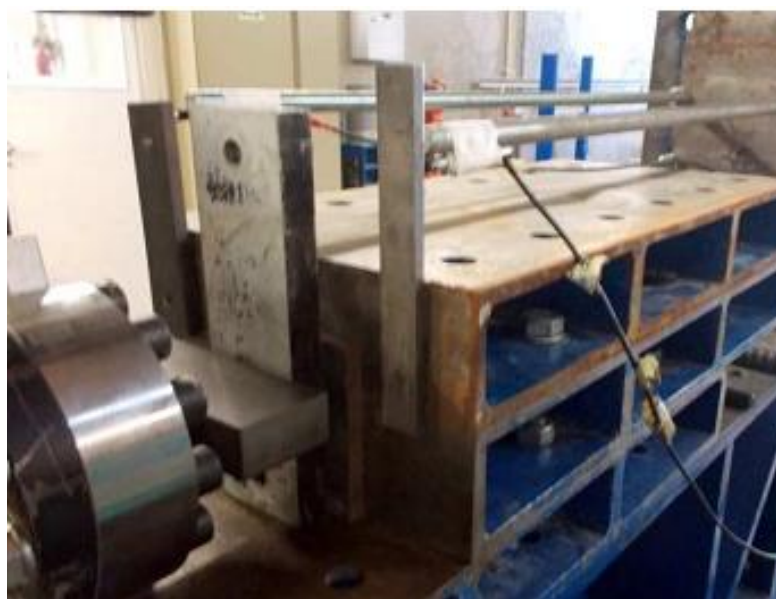
Figura 43 - Avaliação da rigidez do sistema de aplicação de carga e reacção.
