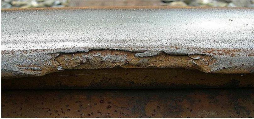
*Figura 3.5 – Degradação de um carril (Guedelha 2012)*
