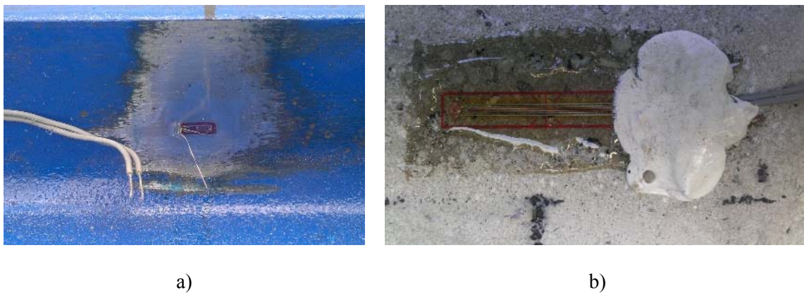
Figura 4.18: Extensómetros na viga metálica (a) e na laje de betão (b)
