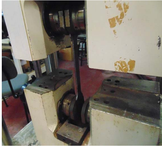
Figura 5.14: Ensaio tração de um provete de aço utilizado no fabrico da viga metálica
