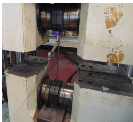
Figura 5.6: Ensaio tração de um provete de armadura
