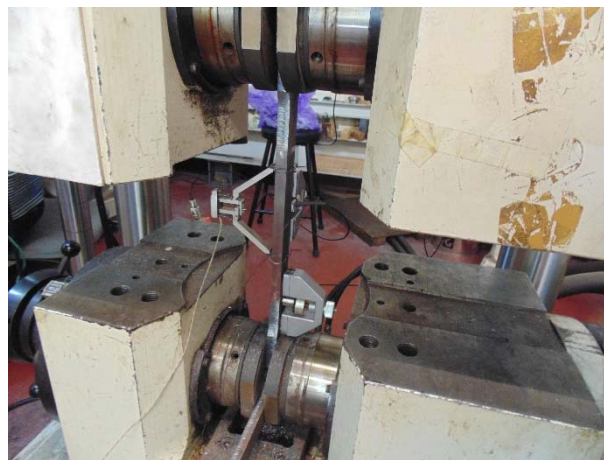
Figura 5.10: Ensaio de tração de um provete de aço utilizado no fabrico do conector
