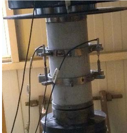
Figura 5.3: Configuração do ensaio para determinação do módulo de elasticidade
