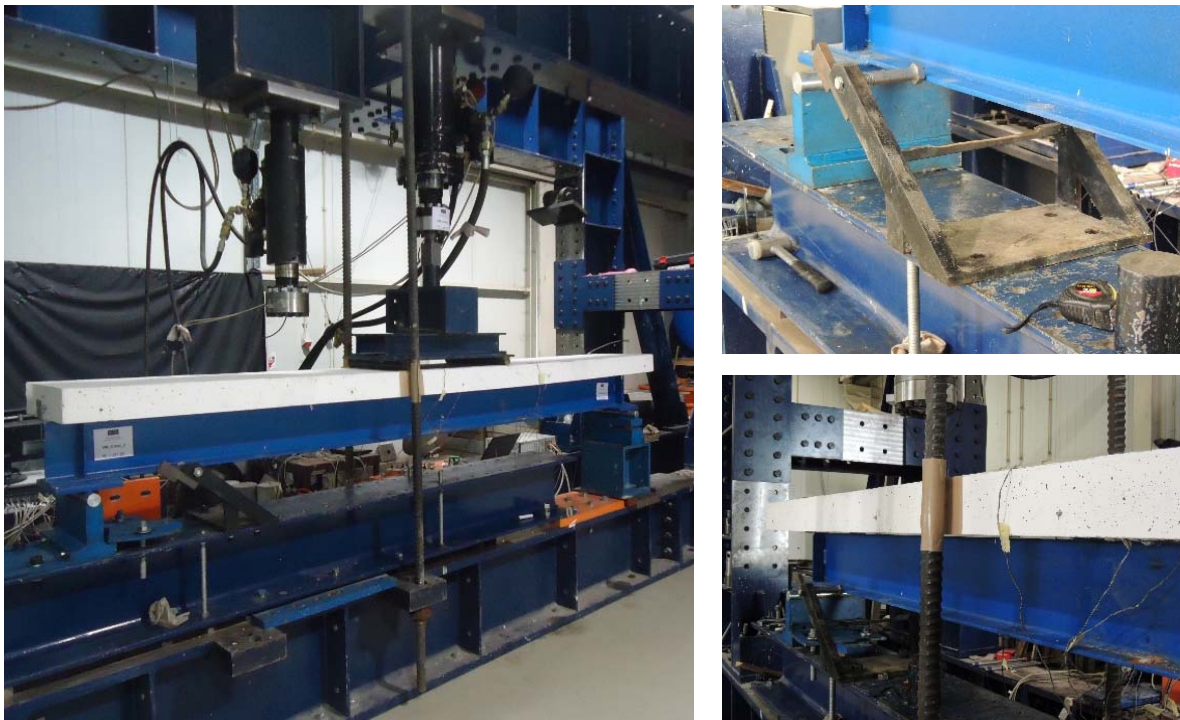
Figura 4.20: Travamento lateral durante o ensaio cíclico
