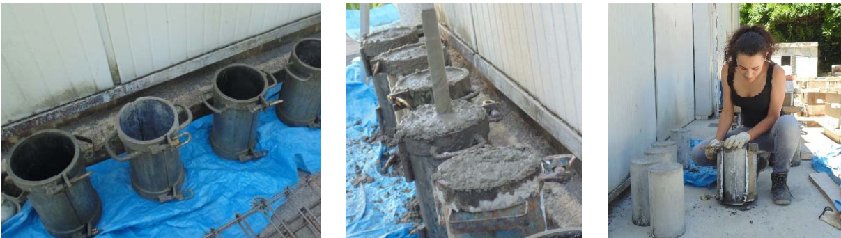
Figura 4.12: Provetes do betão para caracterização dos materiais
