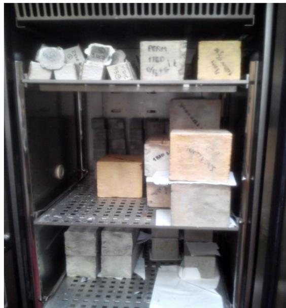
Figura 46 – Provetes no interior da câmara de carbonatação
