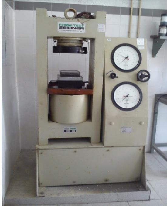
Figura 43 – Prensa para o ensaio de resistência à compressão
