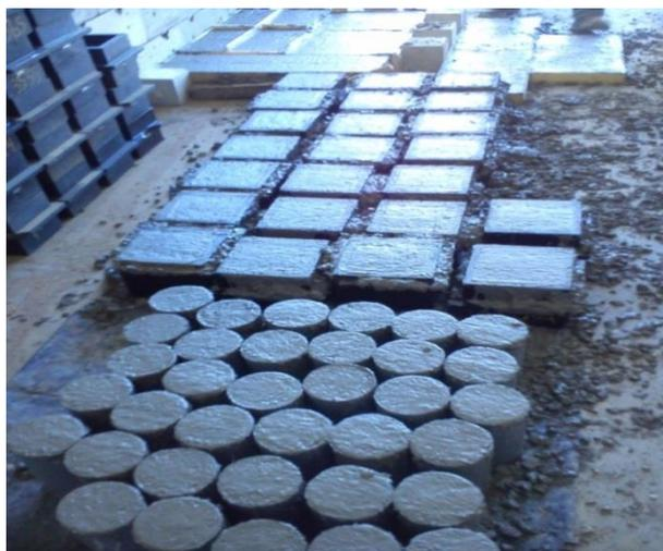
Figura 34 – Moldes após nivelamento do betão
