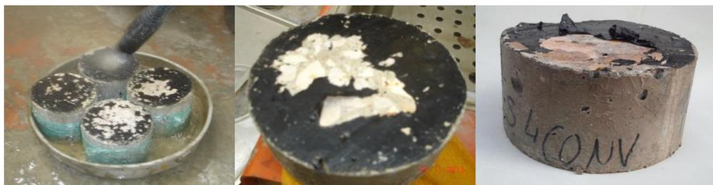
Figura 42 – Processo de remoção da tinta em *spray* da superfície de betão com proteção sacrificial
