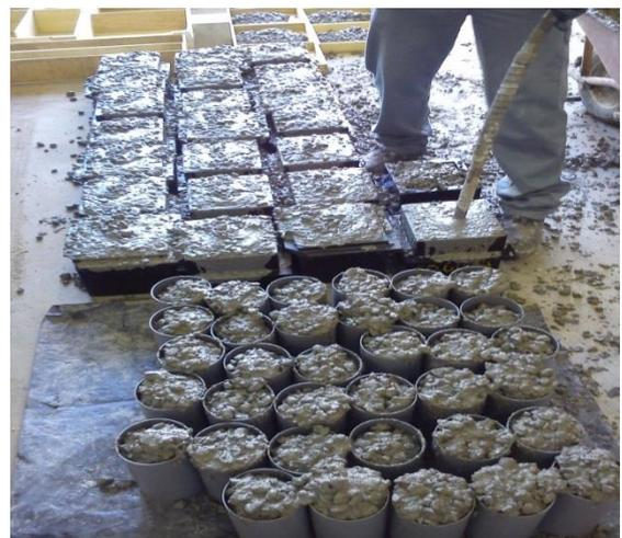
Figura 33 – Compactação do betão por meio de uma agulha vibratória
