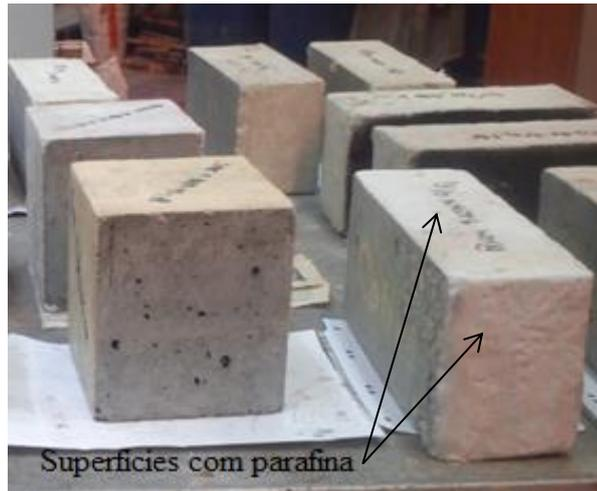
Figura 45 – Provetes impermeabilizados com parafina
