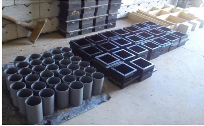
Figura 31 – Moldes destinados à betonagem
