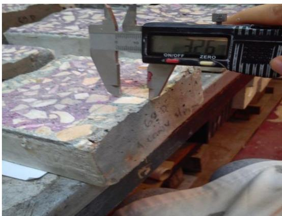
Figura 48 – Medição da profundidade de carbonatação com recurso a um paquímetro digital
