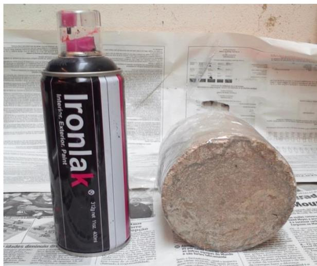
Figura 36 – Tinta em *spray* Ironlack® e provete envolto em película transparente
