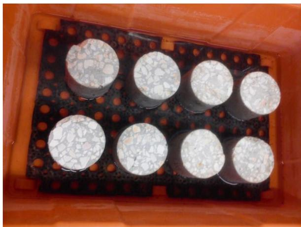
Figura 44 – Provete no tabuleiro durante o ensaio de absorção de água por capilaridade
