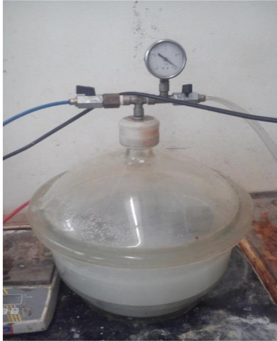
Figura 49 – Câmara de vácuo com solução saturada de  $\text{Ca(OH)}_2$
