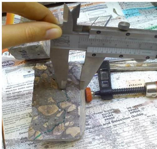
Figura 52 – Medição da profundidade de penetração de cloretos
