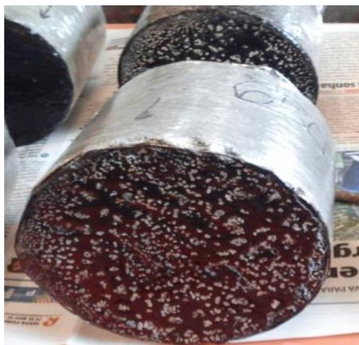
Figura 40 – Provetes com tinta em *spray* aplicada e proteção permanente
