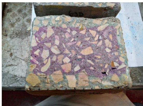
Figura 47 – Superfície pulverizada com a solução de fenolftaleína
