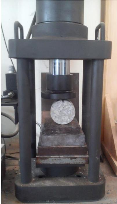
Figura 51 – Compressão diametral do provete
