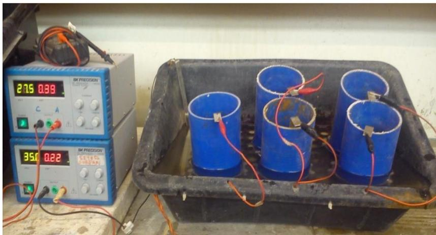
Figura 50 – Provetes no reservatório com solução catódica
