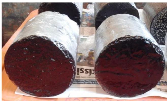
Figura 37 – Provetes pintados com tinta em *spray* Ironlack®
