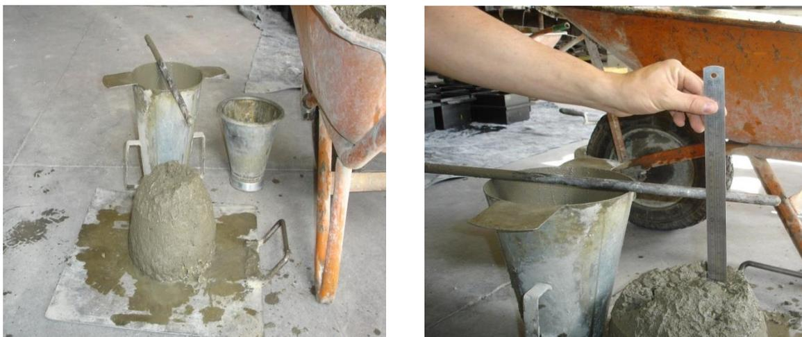
Figura 30 – Ensaio de abaixamento
