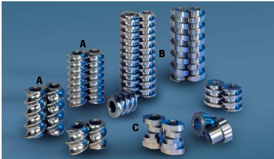
**Figura 5** - Tipos de módulos de fuso. **A** – elementos de fuso co rotativos **B** – elementos de fuso contra rotativos **C** - elementos de fusos reversos [21].
