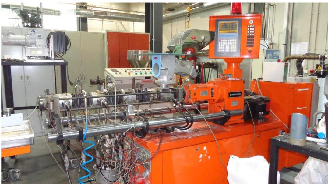
**Figura 10** - Extrusora de duplo-fuso co rotativa *LEISTRITZ*.
