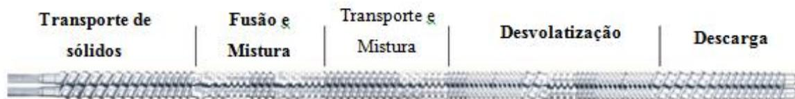
**Figura 3** - Zonas de uma extrusora de duplo-fuso [3].
