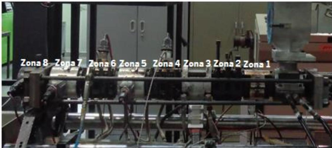
**Figura 11** - Cilindro da extrusora *LEISTRITZ* e as respetivas zonas de aquecimento.
