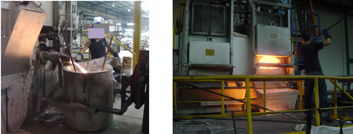
Fig.12 - Recolha para transferência de Alumínio e limpeza da torre fusora
