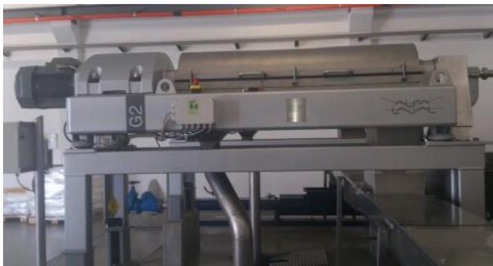
Figura 8. Centrífuga de desidratação da ETAR de Serzedo.
