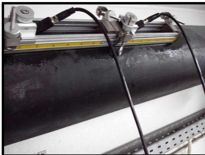
Figura 16 - Aplicação do aparelho ultrassônico na conduta de água de lavagem dos filtros.
