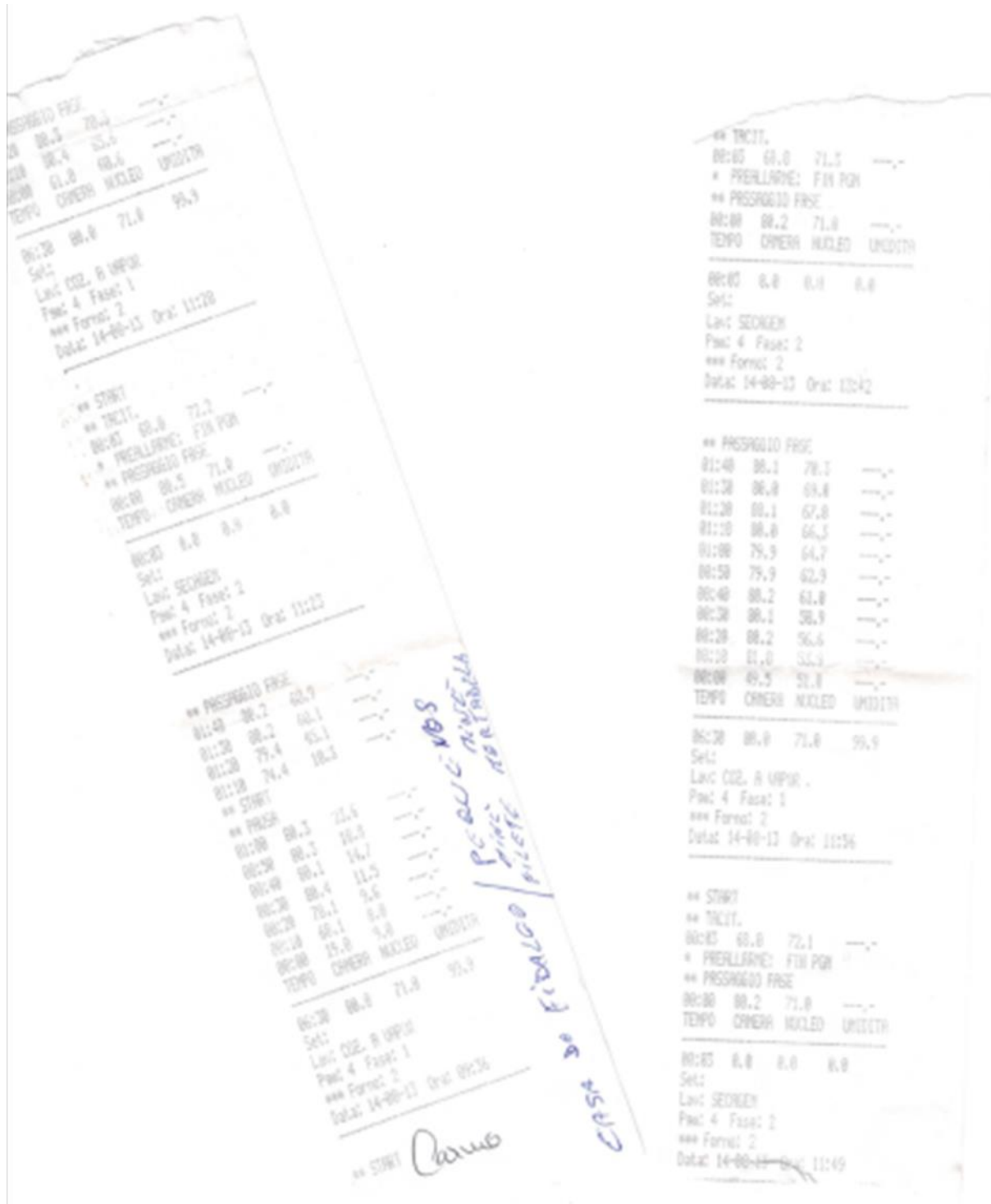
Figura 31: Programa de estufa detalhado com as temperaturas da câmara, do núcleo e a humidade ao longo de todas as fases do tratamento térmico do Fiambre Casa do Fidalgo Meios.
