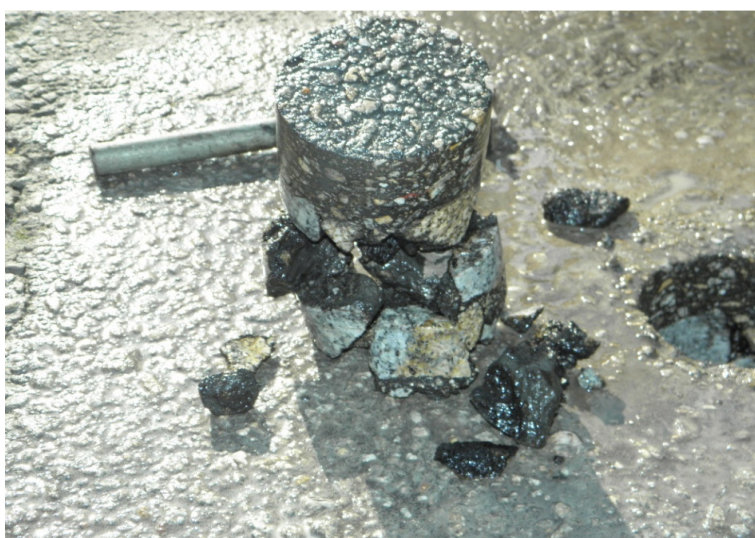
Figura 27- Carote extraído para a determinação das espessuras das camadas ligadas
