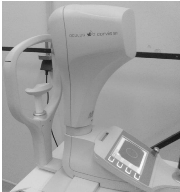
Figura 3.4: Tonómetro Corvis ST utilizado para a obtenção da pressão intraocular.
