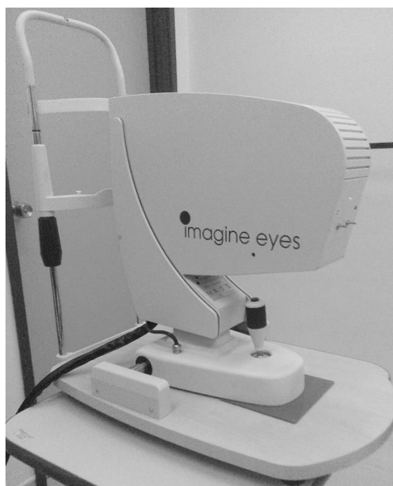
Figura 3.6: Aberrómetro IRX3 utilizado para a análise da aberrometria ocular.
