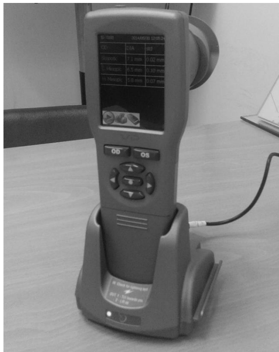
Figura 3.2: Pupilômetro de infravermelhos Neuroptics. Permite a obtenção do diâmetro pupilar para as condições de iluminação: escotópico, mesópico baixo e mesópico alto.
