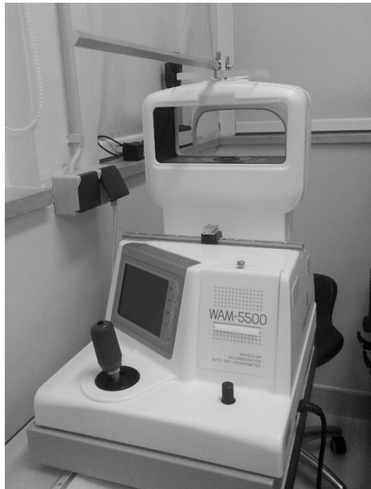
Figura 3.1: Autorrefratômetro de campo aberto GrandSeiko WAM-5500 , utilizado para a obtenção da refração objetiva em duas distintas posições de fixação.
