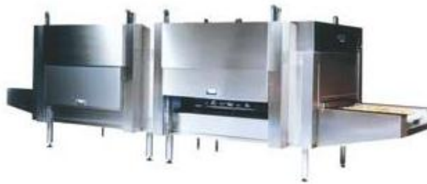
Figura 17 – Túnel de congelação
