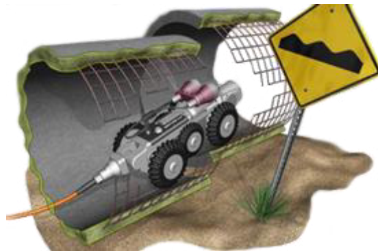
Figura 31 – Sistemas de Circuito Fechado de Televisão (CCTV)
