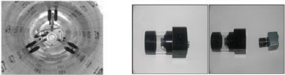
Figura 73 - Da esquerda para a direita: (a) Teste de aquisição de imagem tubular e (b) Sistema CCD de câmara e lentes
