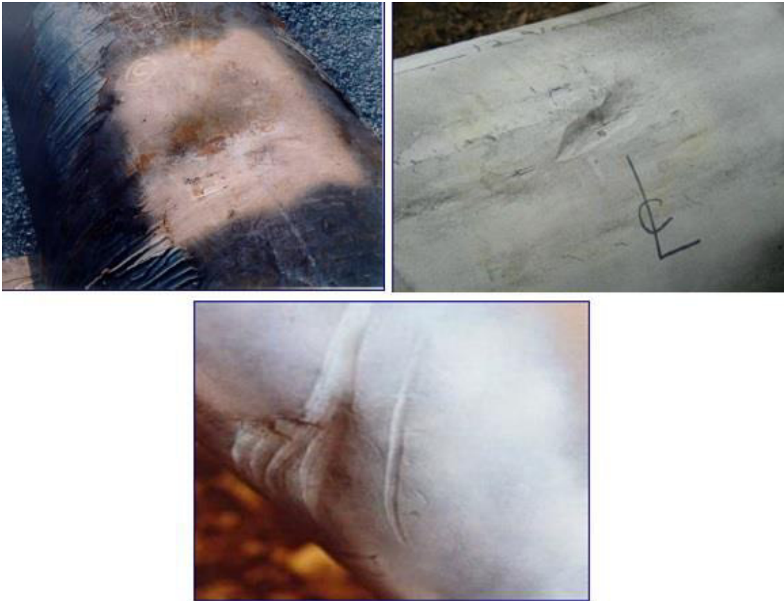
Figura 14-Da esquerda para a direita e para baixo- Entalhe; ranhura; entalhe com ranhura (Winkelman, 2008)
