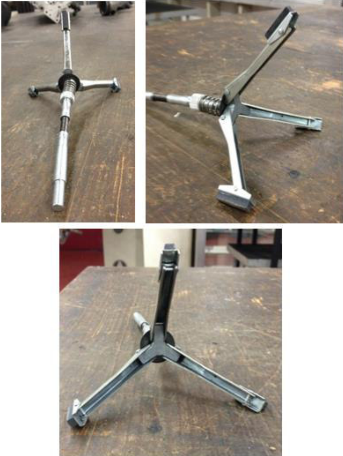
Figura 86 - Vistas traseira, lateral e de frente da suspensão com mola helicoidal seleccionada
