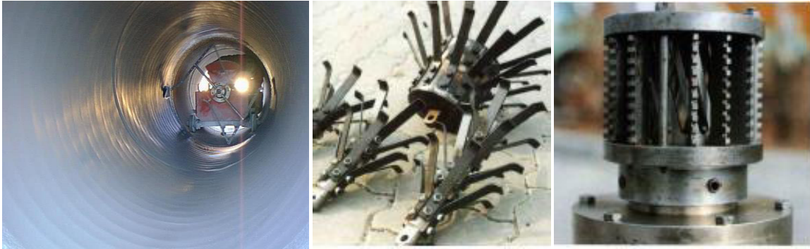
Figura 45 – Da esquerda para a direita: Mecanismo de revestimento com argamassa; Aplicador de argamassa; Raspador de aço
