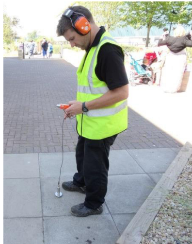
Figura 40 – Detecção Vareta electrónica de escuta
