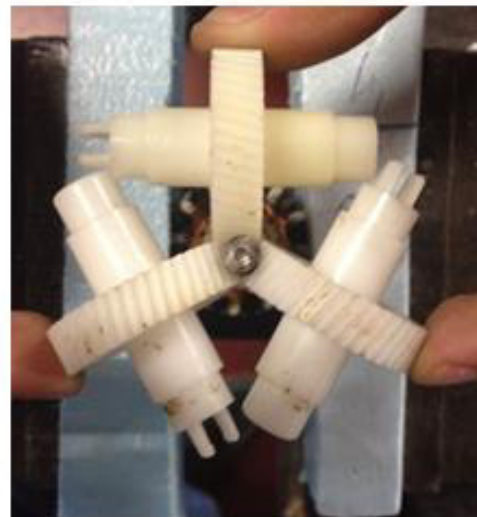
Figura 81 - Disposição das polias em torno do parafuso sem-fim
