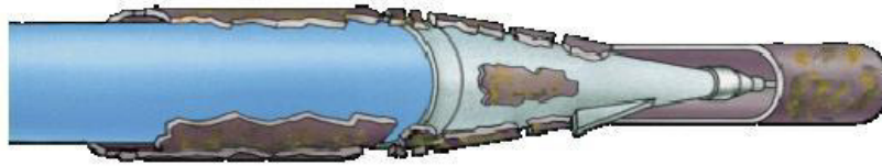
Figura 55 - Destruição da conduta antiga.
