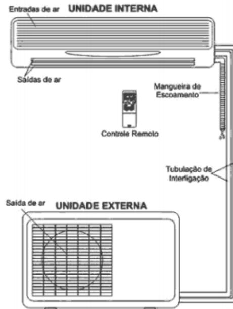
**Figura 2.10** - Esquema e sistema *Split*.
