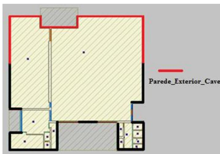
**Figura 3.6** - Parede exterior em contacto com o terreno.
