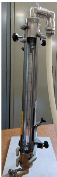
Figura 3.3. Rotâmetro utilizado para medir o caudal de ar movimentado na instalação experimental.
