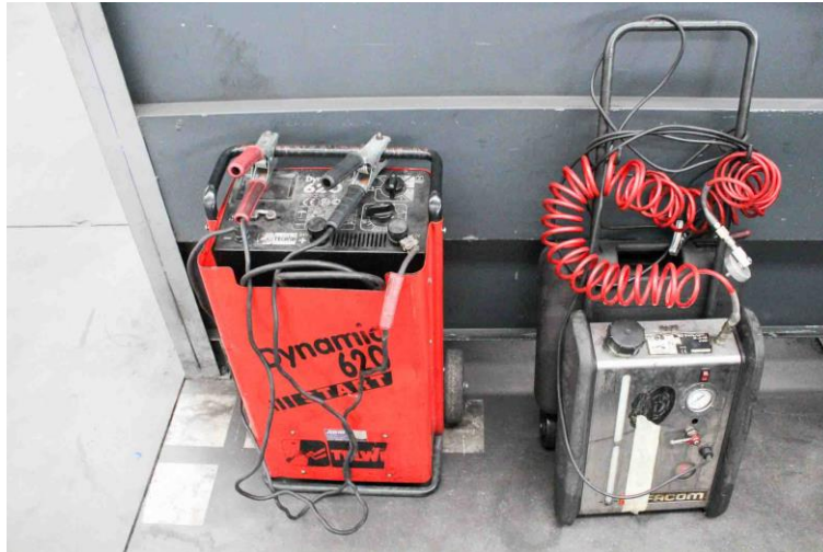
Figura 11 - Equipamento de carga/recarga de baterias e equipamento de substituição de óleo de travões
