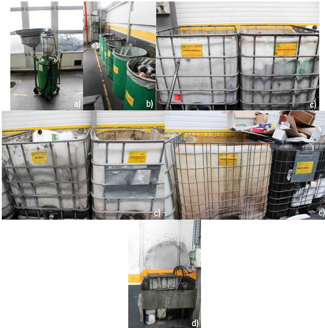
Figura 19 - Sistemas de recolhas de resíduos (sólidos e líquidos) – a) sistema de recolha de óleo das viaturas; b) contentores de resíduos pequenas dimensões; c) contentores de resíduos grandes dimensões; d) local de despejo de líquidos para um reservatório de grandes dimensões
