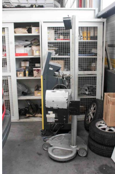
Figura 13 - Equipamento de controlo de emissões CO2 e equipamento de verificação de regulação de faróis
