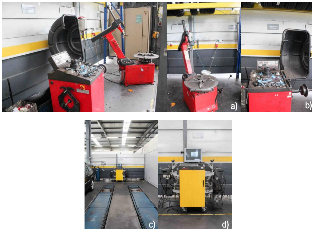
Figura 8 – a) Equipamento de substituição; b) equipamento de calibragem de pneus; c) elevador de alinhamento; d) equipamento de alinhamento
