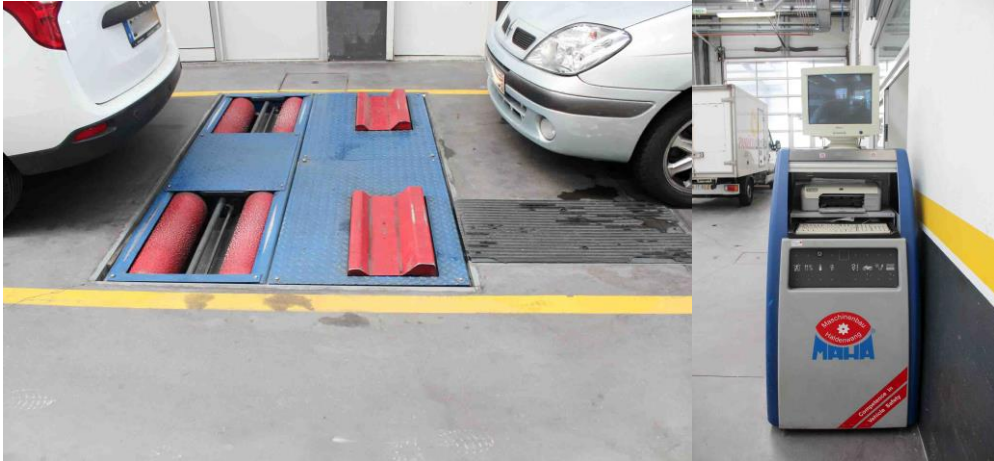
Figura 9 - Equipamento de controlo ao sistema de suspensão e travagem
