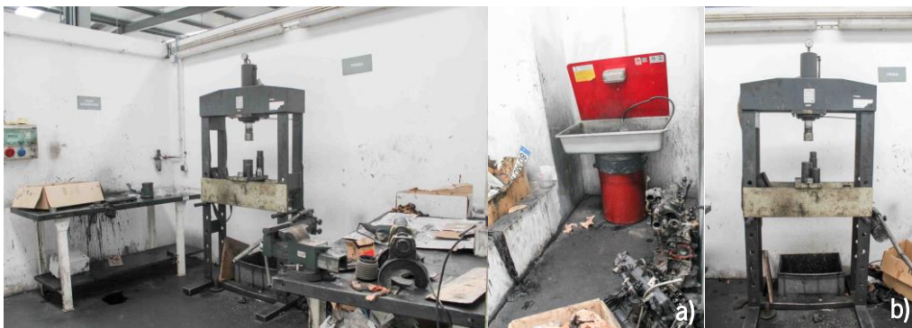
Figura 21 - Equipamento sala de órgãos; a) banca de lavagem de peças; b) prensa hidráulica
