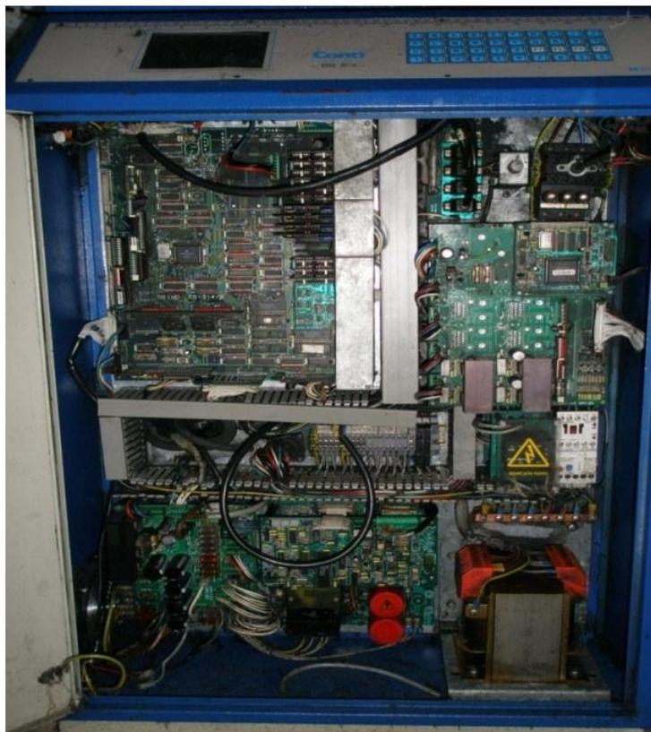
Figura 89 - Placas electrónicas de origem do tear conti F3C
