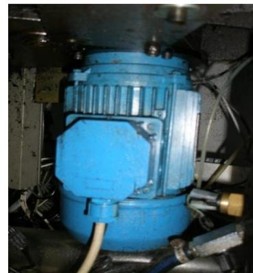
Figura 85 - Motor AC trifásico assíncrono
