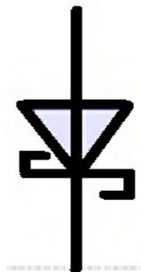
Figura 36 - Símbolo esquemático de um díodo Schottky [14]
