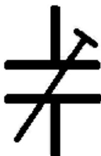
Figura 45 - Símbolo esquemático de um capacitor ajustável [25]
