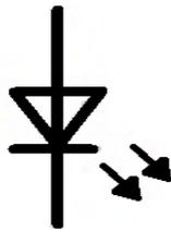
Figura 38 - Símbolo esquemático de um led [14]
