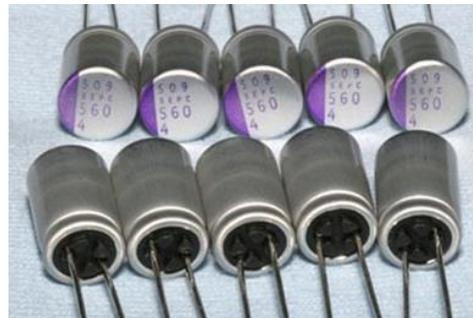
Figura 54 - Capacitores Poliméricos [33]
