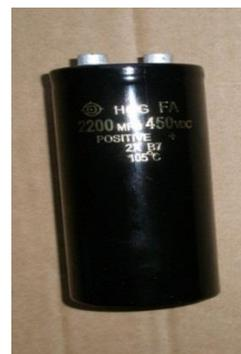
Figura 105 - Capacitor para o variador de velocidade
