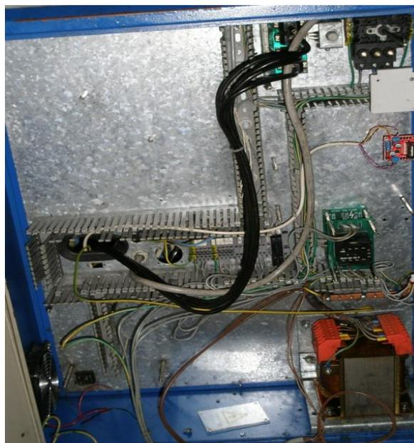
Figura 121 - Imagem do interior da caixa metálica do tear após a sua limpeza e esvaziamento de todo o material dispensado
