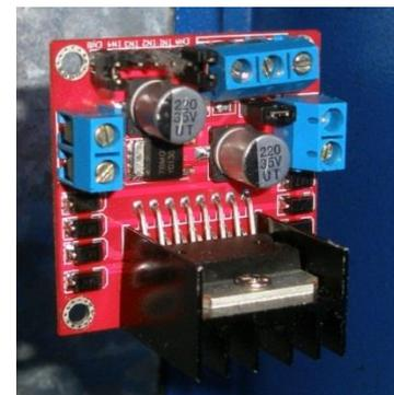
Figura 113 - Placa de acondicionamento de sinal para o motor de passo
