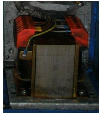
Figura 87 - Transformador de corrente existente no tear
