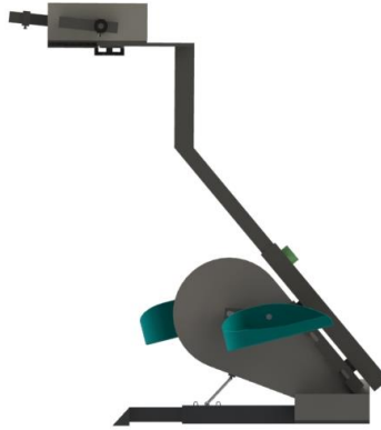
Figura 76 - Situação crítica de funcionamento em altura máxima.
