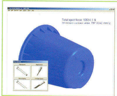
Fig. 4 - Interface do utilizador do programa e representação em 3D de um componente de plástico. Fig. 4 - User interface of the program and 3D representation of a plastic part.
