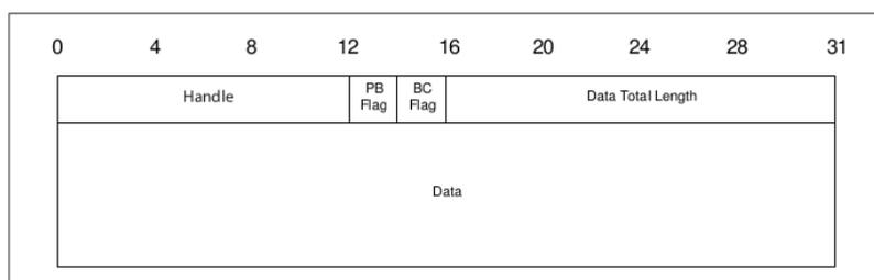
Figura 4.3: HCI ACL Data Packet (imagem retirada de [10]).
