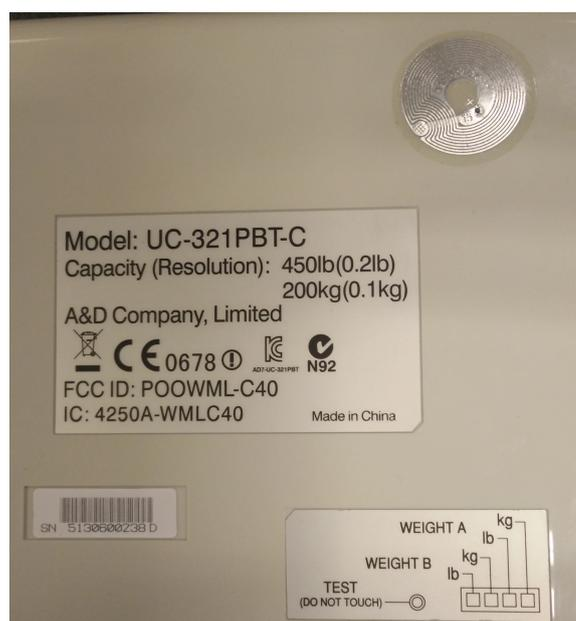
Figura 6.6: NTAG203 colocada na balança UC-321PBT-C.
