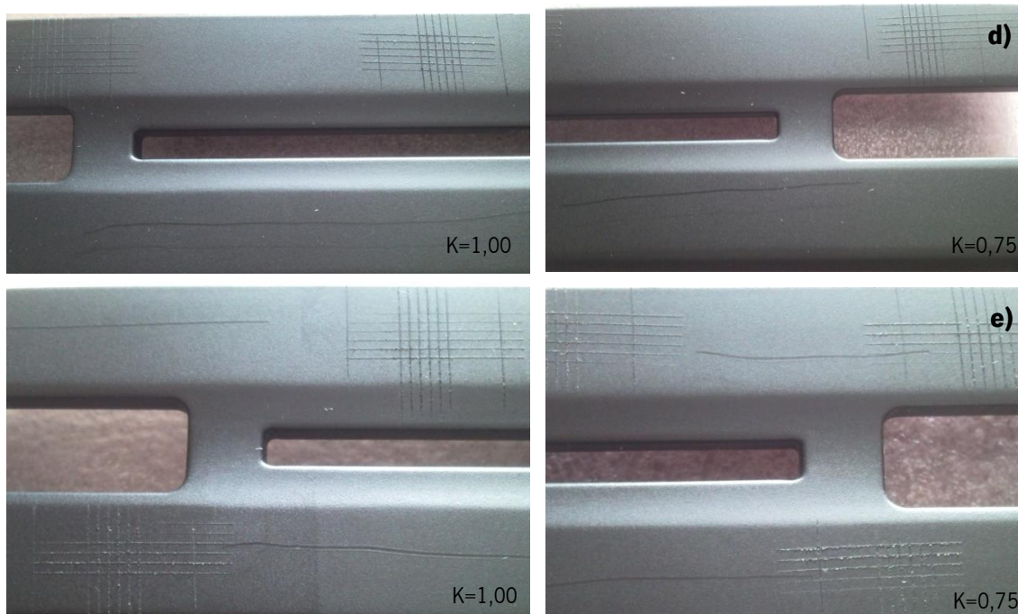
Figura 25. Resultados TL 226: Croscut test e resistência a riscos em a) condições normais; após ensaio de: b) resistência à temperatura (envelhecimento térmico) c) resistência às Intempéries (clima constante com condensação de água) d) resistência ao envelhecimento (envelhecimento por hidrólise) e) resistência a cremes
