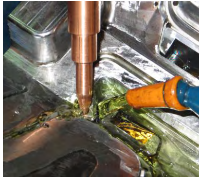
Figura 14 - Erosão por penetração
