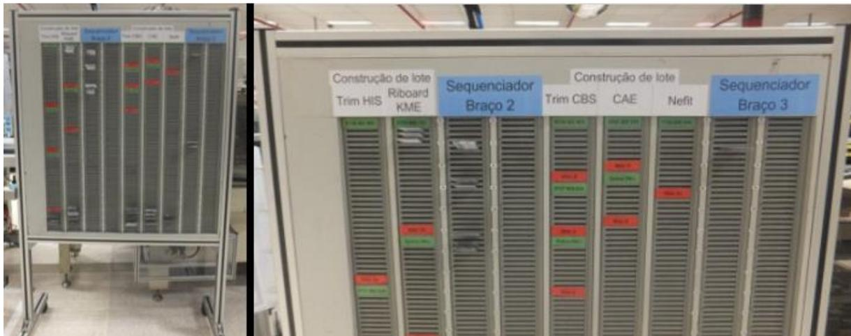
Figura 52 - À esquerda o quadro de construção de lote e sequenciador da montagem manual; à direita uma visão mais pormenorizada do quadro
