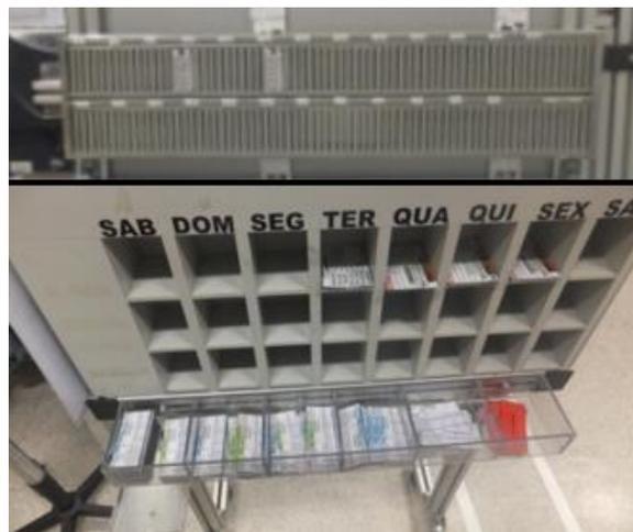
Figura 50 - Traseira do quadro de nivelamento: em cima o sequenciador da montagem final; em baixo a caixa onde a logística coloca o plano de produção para a semana e as caixas de arrumação dos cartões
