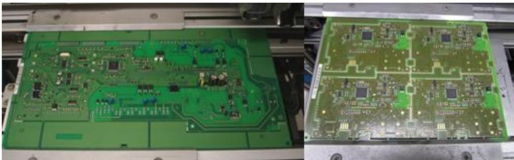
Figura 19 - À esquerda, placa *nutzen* com 1 PCB; à direita, placa *nutzen* com 4 PCB's
