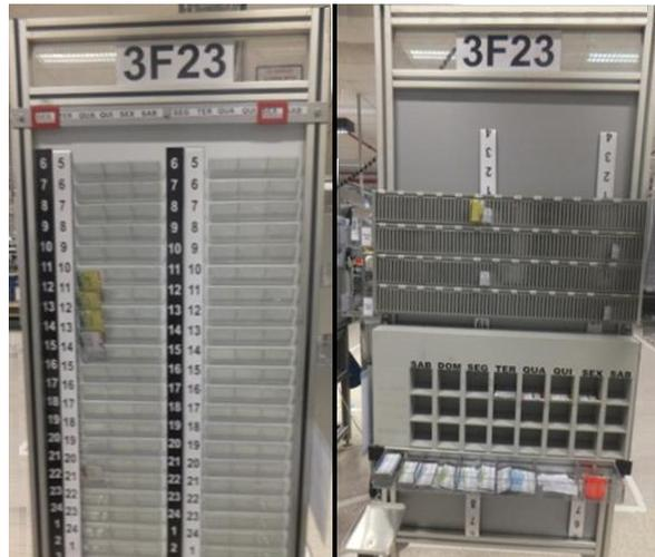
Figura 49 - À esquerda a frente do quadro de nivelamento, onde é colocada a sequência de produção para o dia seguinte (cartões *Master*); à direita a traseira do quadro
