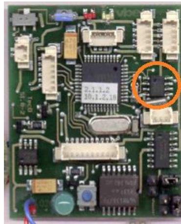
Figura 21 – Smart object com relógio de tempo real [adaptado de:(Beigl &amp; Gellersen, 2003)]
