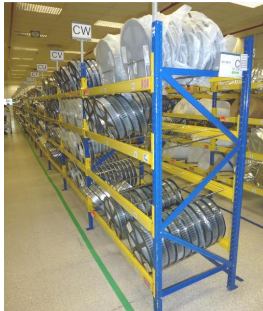
Figura 36 – Estrutura do supermercado avançado SMD
