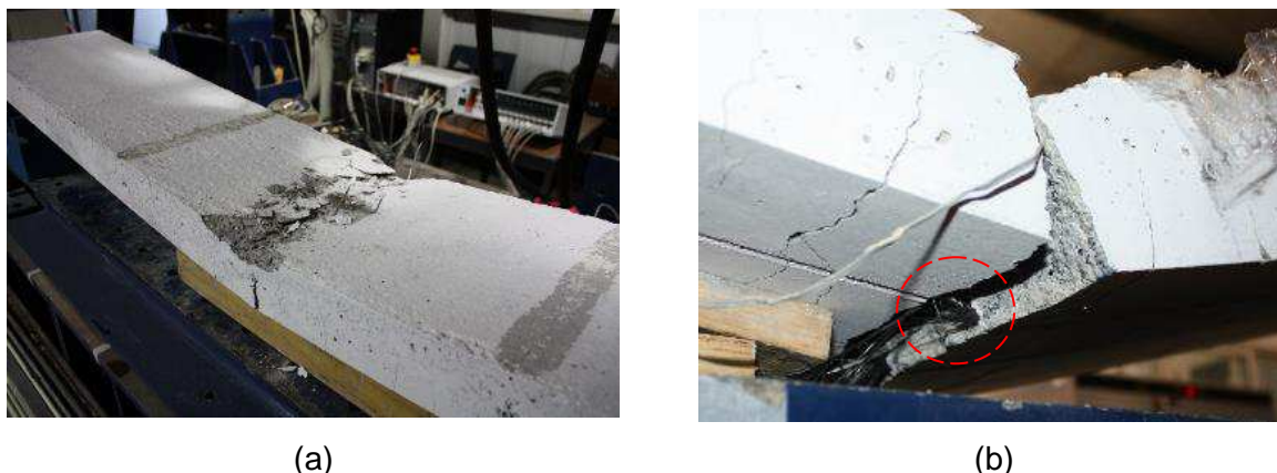
Figura 7. Modos de rotura das lajes: (a) esmagamento do betão; (b) esmagamento do betão + rotura do CFRP.
