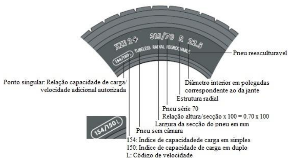
Figura 3.1 - Marcação dos pneus, índices de carga e códigos de velocidade
